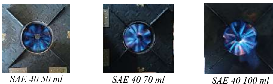
Gambar 5. Warna Api Pada Pembakaran Menggunakan SAE 40
