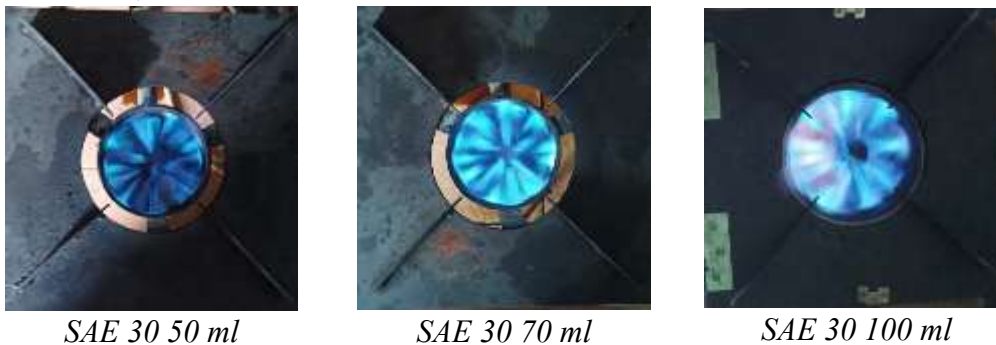
Gambar 4. Warna Api Pada Pembakaran Menggunakan SAE 30
