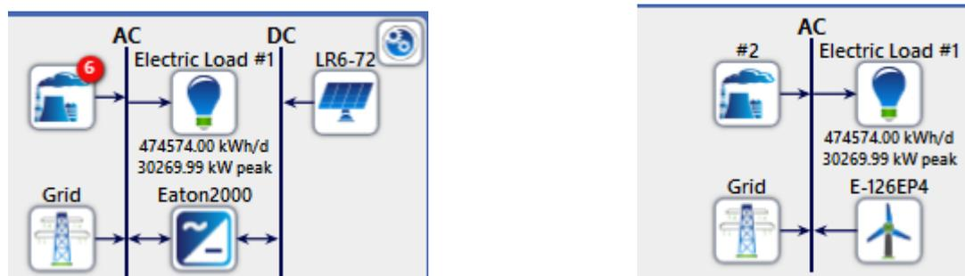
**Gambar 1. Ilustrasi PLTS dan PLTB mode on grid**
