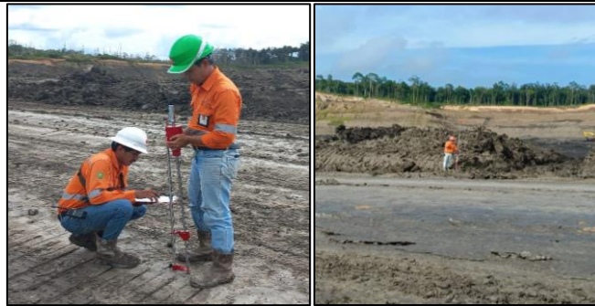
Gambar 13 Pengukuran Data Kekerasan, Lebar, dan Elevasi Jalan
